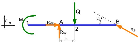
Le equazioni cardinali della statica considerano le componenti lungo gli assi x ed y per cui si scompone la reazione  $R_B$  nelle due componenti  $R_{Bx}$  ed  $R_{By}$ .
