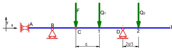
Per risolvere la struttura la si divide in 2 tratti, quante sono le travi, e li si studia singolarmente, con particolare attenzione sulla sezione C dove è posizionata una cerniera su cui agisce la forza F.
