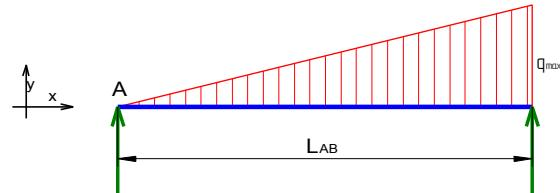
Si consideri una sezione C posta ad una distanza  $x$  dalla sezione A (estremità sinistra della trave) e si ipotizza di tagliare la trave in due tratti AC ed AB.
