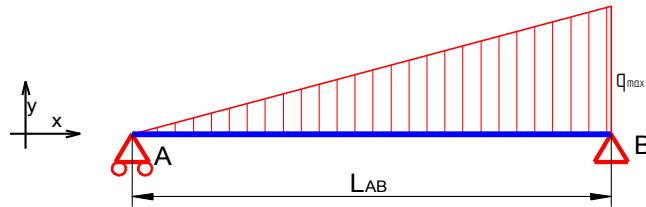
Come prima cosa si calcola il carico localizzato  $\mathbf{Q}$ , equivalente al carico continuo applicato, e la sua posizione; sia  $L_{A1}$  la sua distanza dalla sezione A.
