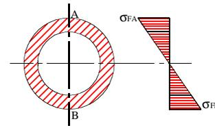
Queste tensioni, come dal diagramma rappresentato in figura, sono di trazione nel punto B e di compressione nel punto A,
