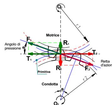
Per il calcolo delle dimensioni dell'albero, considerato che su di esso agisce una sola forza, si effettuerà il calcolo delle reazioni vincolari nel sistema cartesiano  $x' y' z$  ruotato, rispetto al sistema  $xyz$ , di un angolo pari a  $20^\circ$
